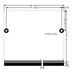
ETA106 模块端面引脚配置:
