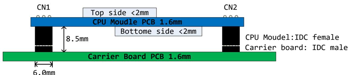
为了防止 ESMARC 工控主板与底板连接出错, ESMARC 规定, CN1. B1 引脚规定为防插反脚, 即: ESMARC 主板上 CN1. B1 脚无插孔, ESMARC 底板上 CN1. B1 脚无插针。
