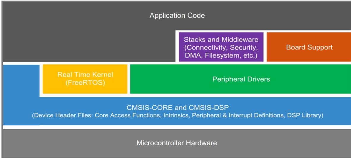
图 1: ESM8400 MCU SDK Layers
