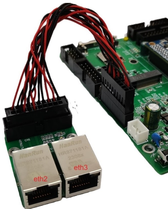
ETA312 引出 eth2 和 eth3 的连接方法
