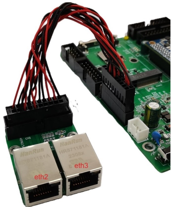
ETA312 引出 eth2 和 eth3 的连接方法
